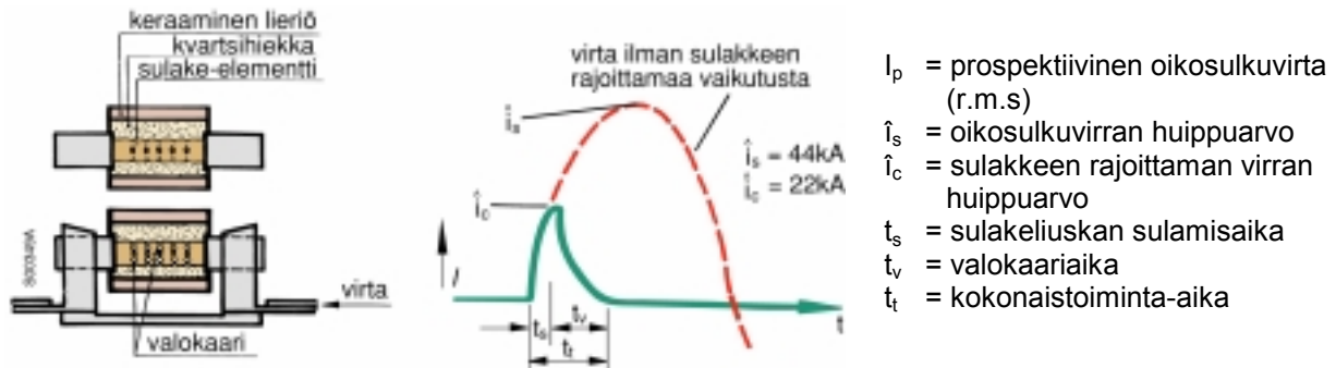
KUVA 7.4c. Kahvasulakkeen rakenne ja toiminta oikosulussa .
