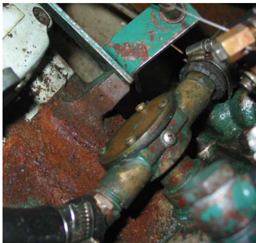
Bild 5.4, bakom lockets 4 skruvar sitter impellern. Vattenpumpen sitter bökiigt till på baksidan av motorn. För att förenkla byte kan man med fördel montera sk "Ping Wings" vilket förenklar både montage och demontage.
