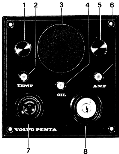
Bild 4.2, motorpanel i sittbrunnen, Den nya vippbrytaren sitter på "plats 5".
