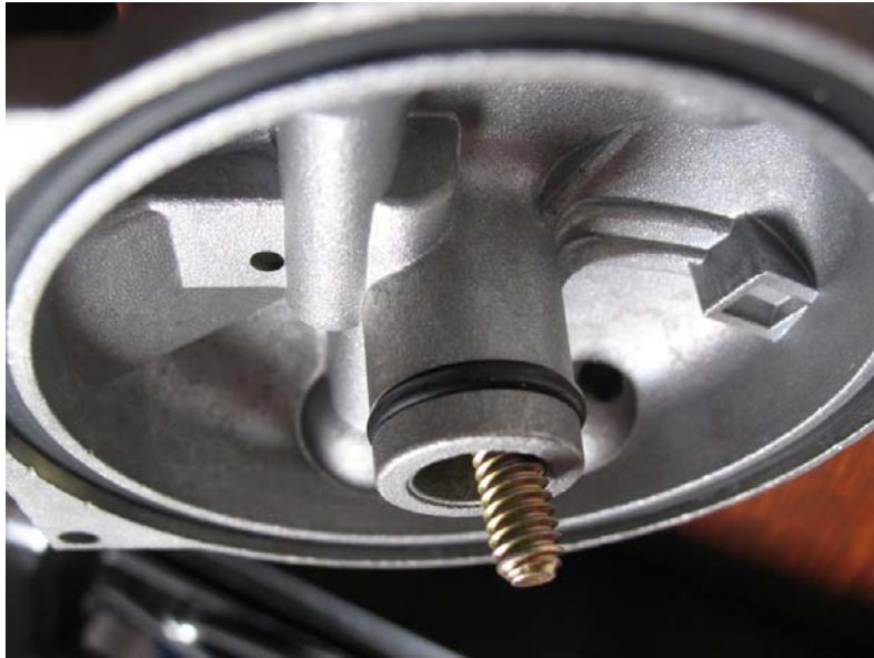
Bild 2.2, Förfilter, här ser man var O-ringarna som är ca 2 cm i diameter sitter. I yttre spåret ser man en av de stora O-ringarna. I mitten den lilla O-ringarna. .
