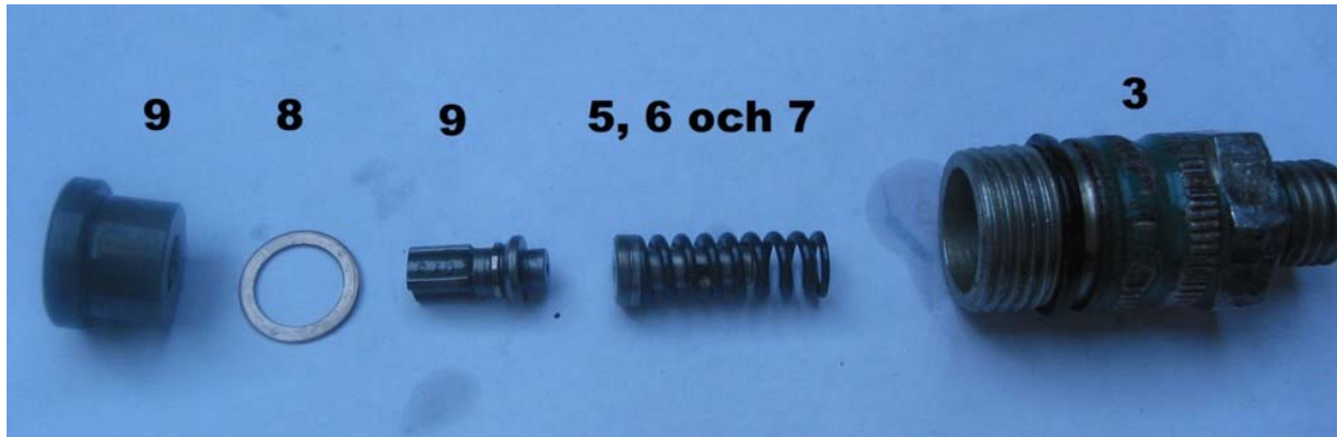
Bild 2.20, bild på tryckventilförslutningen på högtryckspumpen och delarna som "ligger löst". Siffrorna visar delarna enligt sprängskissen bild 1.8. OBS pluggen med bricka och fjäder (5, 6 och 7) är felvänd på bilden.
