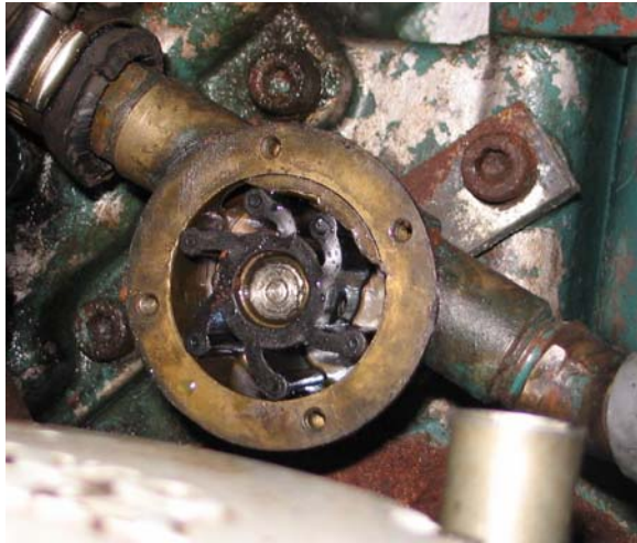
Bild 5.5, bakom locket sitter impellern. Numera sitter sk "Ping Wings" med vingmuttrar som gör att man kommer åt mycket enklare när man ska jobba med vattenpumpen.
