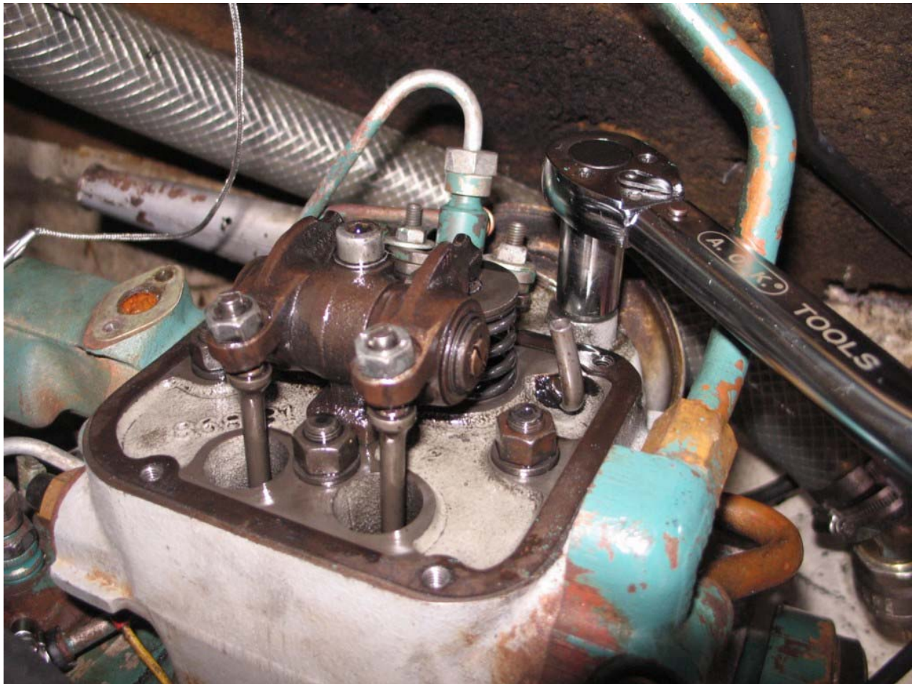
Bild 6.9 Momentnyckeln sitter nu på mutter 3 som dras till 70 Nm.
