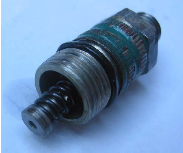
Bild 2.22, Delar i tryckventilförslutningen, Plugg med bricka och fjäder nr 5, 6 och 7 (bulten med en fjäder) är har suttit på detta sätt i vår motor vilket är fel, men har fungerat i alla fall. "Hatten" på pluggen ska vara vänd åt andra hållet.
