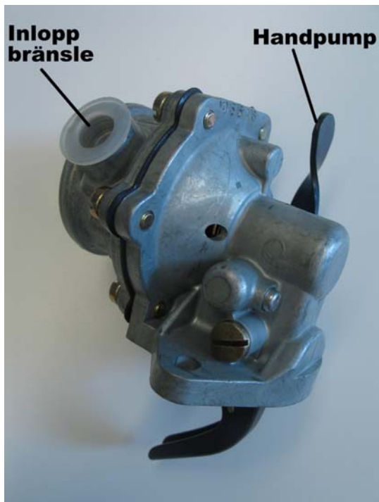
Bild 2.7, ny matarpump (bränslepump) före montage. Vid byte ska man även sätta en ny O-ring mot motorblocket. Handpumpen används för manuell pumpning (handpump) vid luftning.
