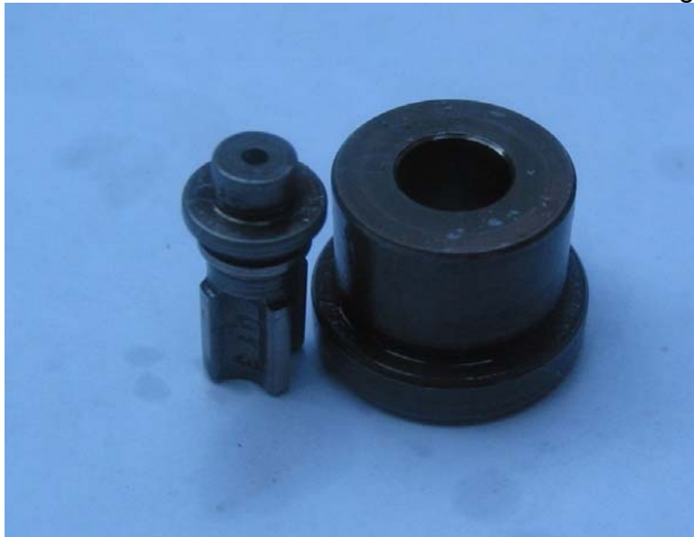
Bild 2.21, Tryckventilen (nr 9) består av två delar. Den vänstra stoppas ner i hålet på den högra. Kopperpackningen tätar mot nederdelen på den fjäderbelastade pluggen.
