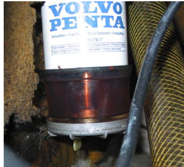
Bild 2.6, förfilter, glaskropp med vit avtappningskran i botten för att tömma vatten. På bilden är glaskroppen fylld med bränsle från Finland. Normalt i Sverige är att bränslet är mer eller mindre glasklart.
