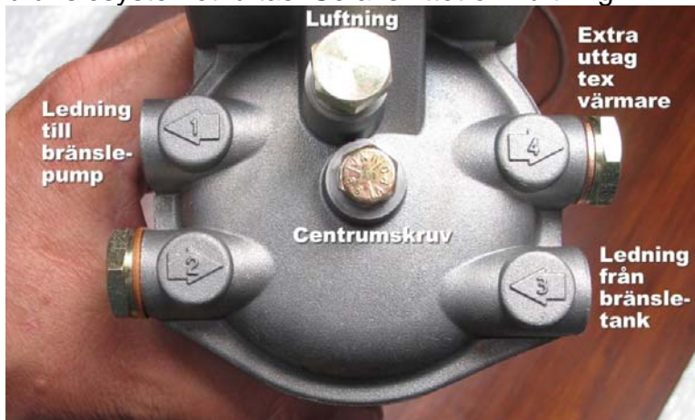
Bild 2.1, Överdelen på förfiltrets hållare (CAV) som monterades sommaren 2006. Notera att man aldrig ska peta på luftningsskruven om man har en sugpump vid motorn, vilket alla MD5:or har.
