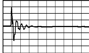
IGBT-vaihtosuuntaaja, 5 \mu s/div, 2A/div
