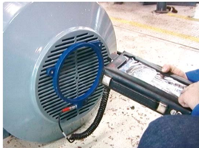
KUVA 5. Staattorin aksiaalisen magneettivuon mittaus moottorin N-päästä (Fortum kuva-arkisto).
