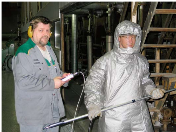
Tauno Juntunen ja Antti Pyykönen mittaavat kuivatussylintereiden pintalämpötiloja.
